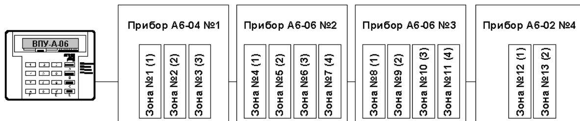
Рисунок 4 – Пример распределения зон в приборах и системе при объединении приборов «А6» при помощи ЖКИ клавиатуры ВПУ-А-06
